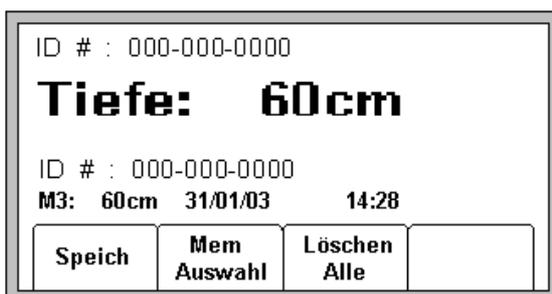
Um alle gespeicherten Einträge zu löschen, drücken Sie den Softkey **Löschen Alle**. Um gespeicherte Einträge anzuzeigen, drücken Sie den Softkey **Mem Auswahl** (ggf. mehrmals).
