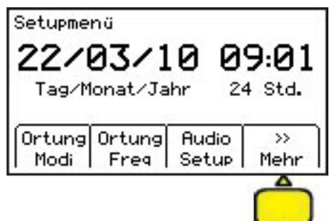
Durch Drücken des Softkeys
