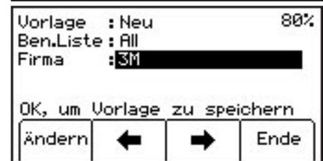
Sollte der zugewiesene Name der Vorlage bereits existieren, kann im folgenden Schirm eine entsprechende Auswahl getroffen werden.
