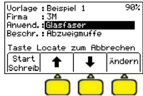
Zur Eingabe der Daten stehen zwei Möglichkeiten zur Verfügung. Entweder kann ein Begriff Buchstabe für Buchstabe manuell eingegeben, oder aus einer Liste von im Gerät abgelegten Begriffen ausgewählt werden. Falls gewünscht kann die angewählte Zeile komplett gelöscht werden.
