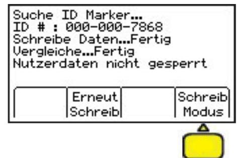
Wird zu Beginn des Schreibvorgangs festgestellt dass bereits Daten im Marker vorhanden sind, aber in der Konfiguration „**überschreib Nein**“ eingestellt, wird eine entsprechende Fehlermeldung angezeigt. Drücken Sie den rechten Softkey um in den Schreib Modus zurückzukehren.
