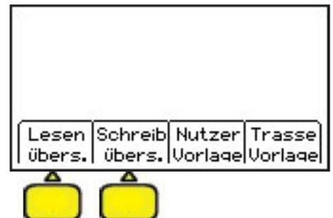
Die Liste der max. 100 letzten geschrieben bzw. gelesenen Marker wird mit Datum, Uhrzeit und Seriennummer des Markers angezeigt. Benutzen Sie die Pfeiltasten um einen Eintrag markieren. Drücken Sie den Softkey **Ende** um zum Menü zurückzukehren. Drücken Sie den Softkey **Marker Details** um die Markerdaten anzuzeigen.
