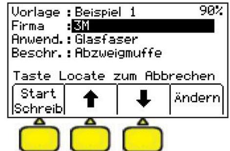
Der Schreibvorgang wird gestartet. Das Gerät sucht nach einem RFID-Marker, zeigt dessen Seriennummer an, schreibt die Daten in den Marker und vergleicht die Daten mit der Vorlage.
