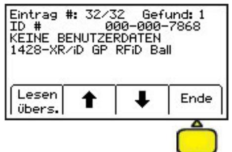
Bei vorhandenen Benutzerdaten werden diese unterhalb der Seriennummer angezeigt. Der Pfeil rechts am Bildrand signalisiert weitere Daten, die durch Druck auf den Softkey sichtbar gemacht werden können. Drücken Sie den Softkey **Ende** um zur Markerortung zurückzukehren.
