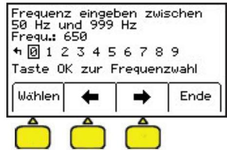
Die eingegebene Frequenz wird nun als aktiv in der Liste der Aux- Frequenzen angezeigt und ist bei der Kabelortung unter den Aux- Frequenzen verfügbar. Im Feld darunter kann ausgewählt werden, welcher Netzfilter bei der Verwendung der benutzerdefinierten Frequenzen benutzt werden soll.
