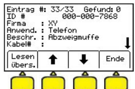
**Achtung:** Ein Löschen von Markerdaten im Gerät ist nicht möglich. Um Markerdaten zu löschen, müssen diese mit der PC Locator Tools Software auf den PC übertragen werden und dann gelöscht werden. Werden mehr als 100 Marker gelesen oder geschrieben, wird der jeweils erste Datensatz im Gerät überschrieben.
