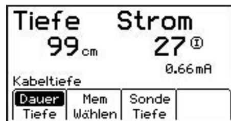
Mit dem Softkey **Tiefe** kann zwischen einer Dauermessung und einer Einzelmessung umgeschaltet werden. Bei der Dauermessung wird die ungefähre Verlegetiefe ständig berechnet und angezeigt.
