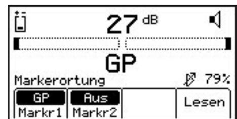
Gehen Sie anschließend den Bereich des vermuteten Markers, das Gerät nach links und rechts pendelnd, ab. Sollten Sie sich dabei einem Marker nähern, füllt sich die Balkenanzeige, der numerische Wert der relativen Signalstärke wird größer und die Lautstärke des Lautsprechers nimmt zu. Sollte die Balkenanzeige komplett geschlossen sein, bleiben Sie stehen und drücken Sie die Taste **GAIN -**.
