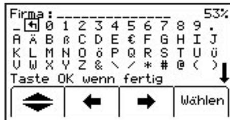
Bewegen Sie den Cursor mit den Pfeiltasten zum Symbol „Pfeil nach links“, um bestehenden Text (sichtbar am oberen Bildrand) zu löschen. Benutzen Sie zur Navigation der Einfügemarke die Pfeiltasten und zur Auswahl der Zeile den Doppelpfeil. Drücken Sie jeweils den Softkey **Wählen** um ein Zeichen zu übernehmen (oder im Fall des Symbols „Pfeil nach links“ das letzte Zeichen des Textes zu löschen).
