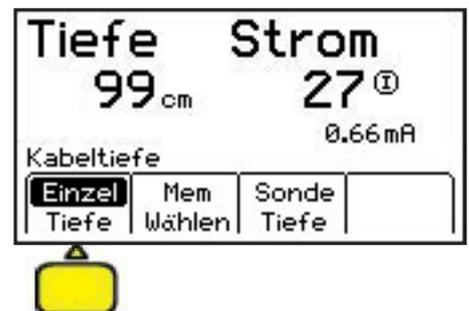
Im Gerät können bis zu fünf Messwerte inklusive des relativen Signalstroms, Datum und Uhrzeit gespeichert werden.
