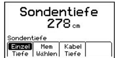
Mit dem Softkey **Tiefe** kann zwischen einer Dauermessung und einer Einzelmessung umgeschaltet werden. Bei der Dauermessung wird die ungefähre Verlegetiefe ständig berechnet und angezeigt. Bei der Einzelmessung wird für ca. 3 Sekunden die ungefähre Verlegetiefe ermittelt (nur Striche in der Anzeige) und anschließend der Mittelwert angezeigt.
