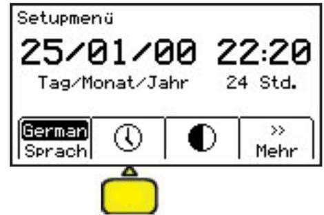
Benutzen Sie die Pfeiltasten um die Markierung nach links oder rechts zu bewegen und stellen Sie Datum und Uhrzeit mit der + oder - Taste ein. Ist die Zeile unterhalb des aktuellen Datums angewählt, kann mit den + oder - Tasten zwischen dem amerikanischen und dem deutschen Datumsformat umgeschaltet werden (MM/TT/JJ oder TT/MM/JJ).
