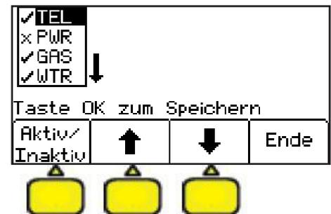
Der Haken vor dem gewählten Eintrag wird gelöscht und dieser Markertyp / Frequenz wird nicht mehr in der Typauswahl der Markerortung angezeigt und ist somit bei der Markerortung nicht mehr verfügbar. Drücken Sie anschließend die Taste **Menu/OK** um die Änderung zu speichern,
