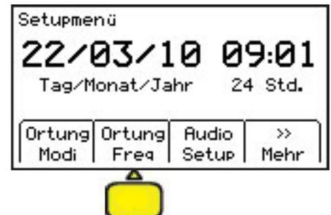
Wählen Sie mit den Pfeiltasten die entsprechende Frequenz in der gewünschten Spalte an und drücken Sie dann den Softkey **Aktiv/Inaktiv**. Aktive Frequenzen werden mit einem Haken vor der Frequenz angezeigt. Drücken Sie anschließend die Taste **Menu/OK** um die Änderung zu speichern,
