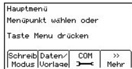
Die gewünschte Funktion wird mittels den Pfeiltasten angewählt und anschließend mit der **Menu / OK** Taste bestätigt.
