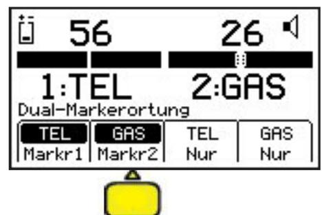
Stellen Sie die Grundempfindlichkeit ein. Stellen Sie dazu sicher, dass sich kein Marker in der Nähe befindet. Drücken Sie die Taste **GAIN** - so oft, bis Sie aus dem Lautsprecher nur noch ein ganz leises Signal (Rauschen) hören.
