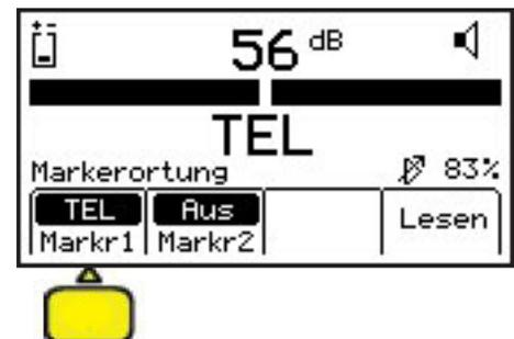
Sollen zwei Marker mit unterschiedlichen Frequenzen geortet werden, wählen Sie mit dem Softkey **Markr2** die zweite Frequenz aus. In dieser Betriebsart kann nur die Ortung durchgeführt werden. Zur Tiefenbestimmung, bzw. zum Auslesen von RFID Markern muss zur Einzelansicht (Softkey **TEL Nur** bzw. **GAS Nur**) zurückgekehrt werden.
