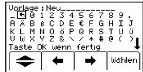
Benutzen Sie die Pfeiltasten um zur ersten Spalte der dritten Reihe zu gelangen. Hier wird die erste Bezeichnung eingegeben. Drücken Sie die Taste **Ändern**.
