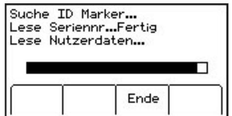
Die im Marker abgelegten Daten werden angezeigt. Sind keine Benutzerdaten einprogrammiert, werden nur die Seriennummer und der Markertyp angezeigt. Drücken Sie den Softkey **Ende** um zur Markerortung zurückzukehren.
