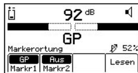
Wird kein RFID-Marker gefunden, wird dies im Display angezeigt.
