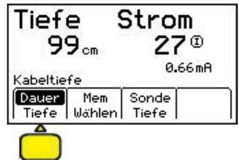
Bei der Einzelmessung wird für ca. 3 Sekunden die ungefähre Verlegetiefe ermittelt (nur Striche in der Anzeige) und anschließend der Mittelwert angezeigt.
