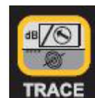
Displayanzeige in **Maximum** Modus. Drücken Sie den Softkey **Modus** um in den Minimum Modus zu wechseln.
