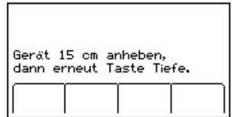
Der Empfänger berechnet die Tiefe des Markers („Berechne, Bitte warten...“) aus beiden Messungen und zeigt dann die ungefähre Verlegetiefe an.
