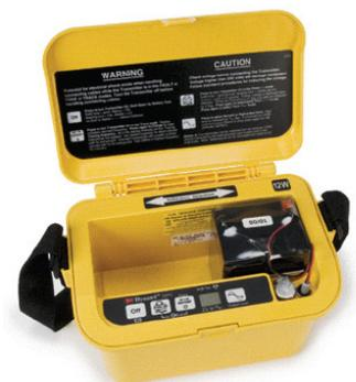
Laden Sie die externe Batterie nur mit dem mitgelieferten Ladenetzteil. Um die maximale Lebensdauer der Batterie zu gewährleisten, sollte die Batterie nicht länger als 72 Stunden am Ladenetzteil verbleiben.
