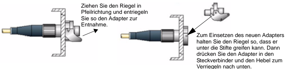
Abb. 3 Ausbau und Einbau eines Adapters
