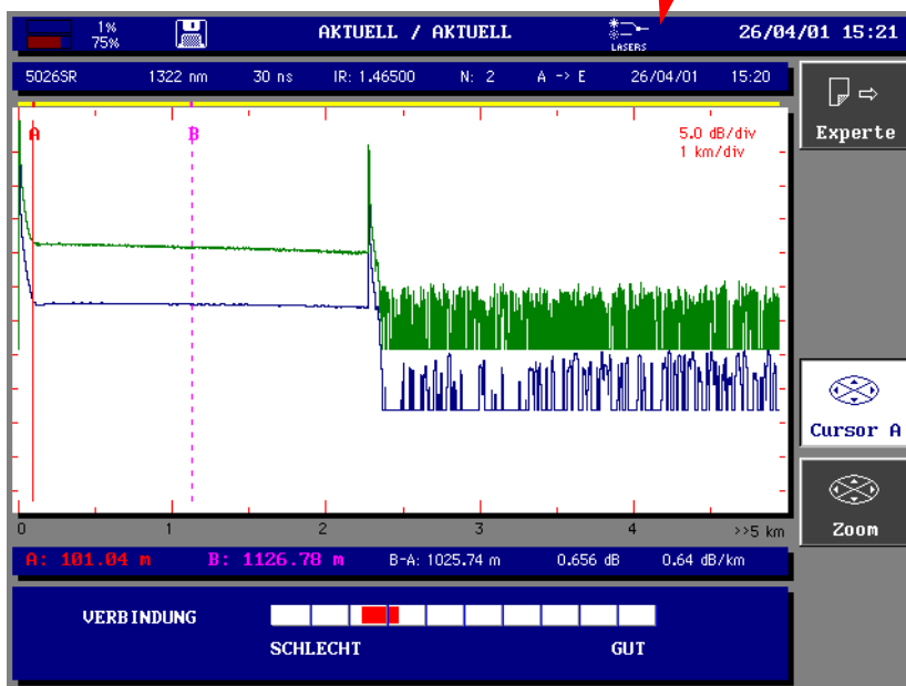
Beispiel einer Messwertaufnahme mit zwei Wellenlängen
