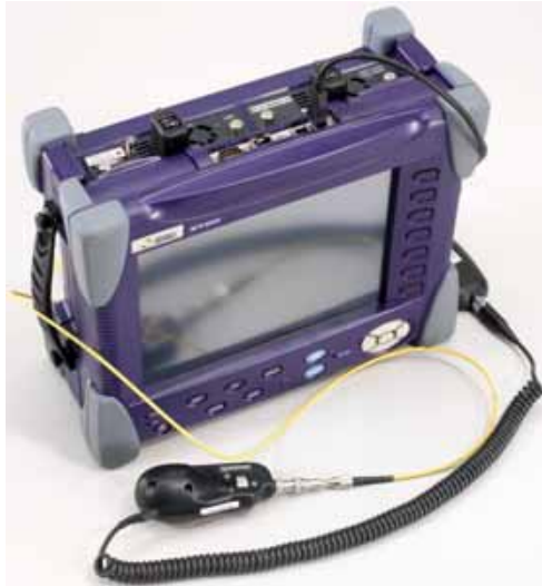
Abb. 40 Grundgerät 8000 mit USB-Mikroskop zur Überprüfung eines optischen Anschlusses
