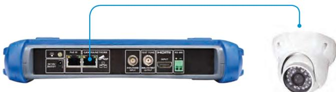
PoE+-Stromversorgung der Kamera bis 24 W über den RJ45-Anschluss des Testers.
