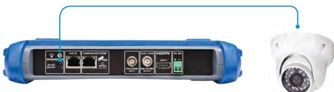
Stromversorgung der Kamera über den Klinkenstecker (2,5 auf 3,5 mm, 12 VDC/2 A) vom Tester.
