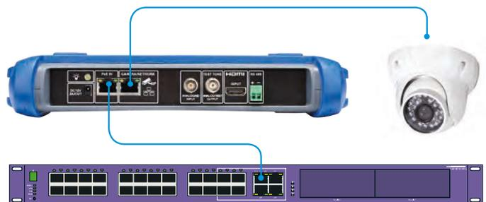
Stromversorgung der Kamera über den RJ45-Anschluss durch eine PoE+-Schleife vom Netzwerk durch den Tester hindurch.
