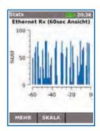
Echtzeit-Anzeige des Verkehrs im Broadcast-Netzwerk in Prozent der Port-Rate der vergangenen 60 Minuten.
