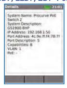
Anzeige der Port-Daten mit Hilfe des Extreme Discovery Protocol (EDP), des Link Layer Discovery Protocol (LLDP) und des Cisco Discovery Protocol (CDP).
