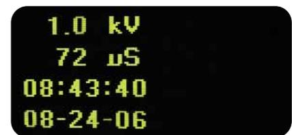
**Spitzen-Detail:** Schnelle Reaktion erfasst positive wie negative Spitzen bis 4 kV.
