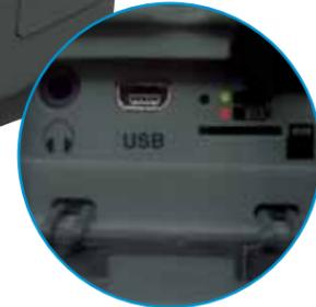
Seitenklappe für schnellen Zugriff auf Kopfhörer- und USB-Anschlüsse, Ladeschnittstelle und austauschbare Mikro-SD-Karte
